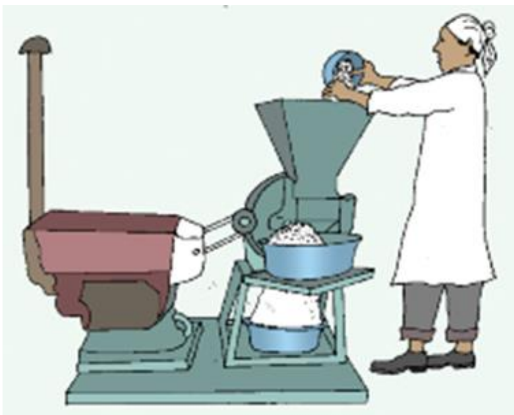
Figure 39. Poudrage (transformation en farine panifiable)
