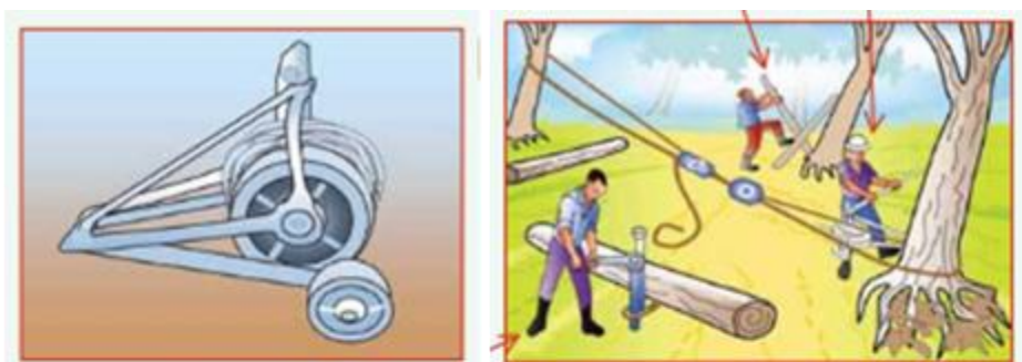
a) Treuil pour singe est utile pour abattre des arbres et arracher les racines
